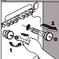
Гаечным ключом на 10 мм удалите два винта и две шпильки с задней панели машины.
