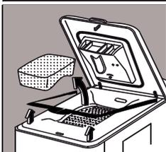
Откройте крышку стиральной машины и выньте приспособления, предотвращающие вращение барабана, и пластиковую прокладку. Закройте крышку.
