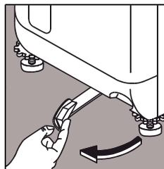
Если вы хотите переставить стиральную машину, поднимите ее на колесики – для этого поверните рычаг внизу машины влево. После того, как машина будет установлена на нужное место, установите рычаг в исходное положение.
