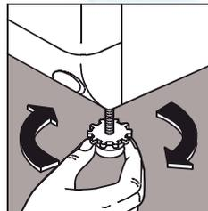
Выровняйте положение машины, регулируя слишком короткую ножку. Выкрутите вместе основание ножки и блокировочное кольцо (при необходимости поднимите стиральную машину). Когда машина примет устойчивое положение, закрутите до упора блокировочное кольцо, удерживая основание ножки на полу.
